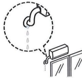
エアコンの水漏れ
